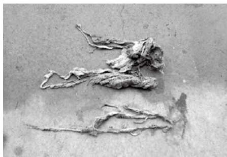
水に溶けない紙が固まりポンプに詰まります
