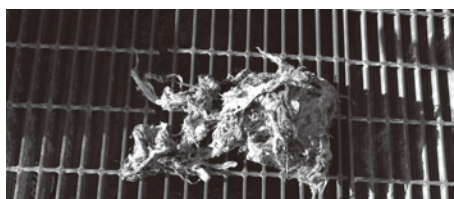
ポンプに詰まったウェットティッシュ
