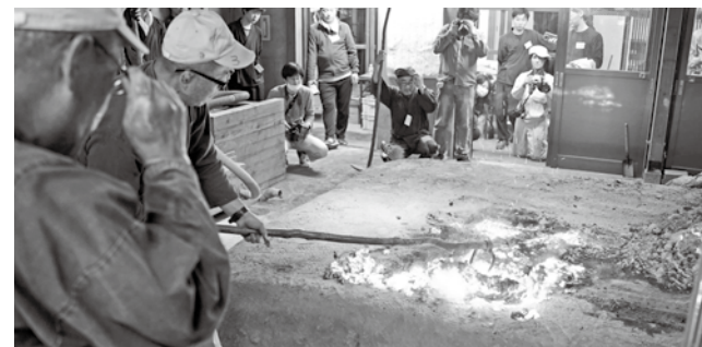
▲炉を崩して鉄の塊「鍋」を取り出す
