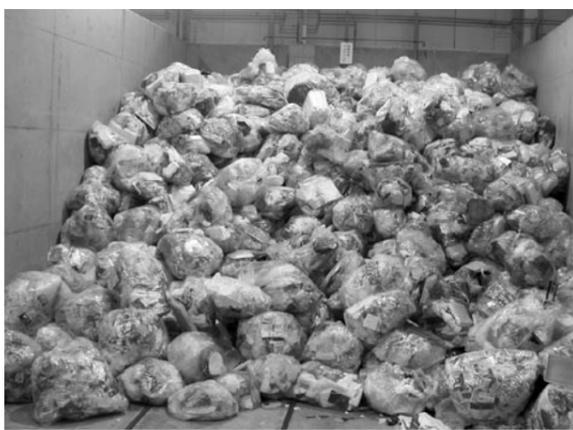
**1** 収集された容器包装プラスチック類とペットボトルは、別々の貯留ヤードにストックされます。その後、受入ホッパに投入され、ベルトコンベアで運ばれます。
