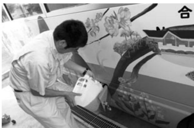
廃食用油燃料を給油する環境衛生課職員
