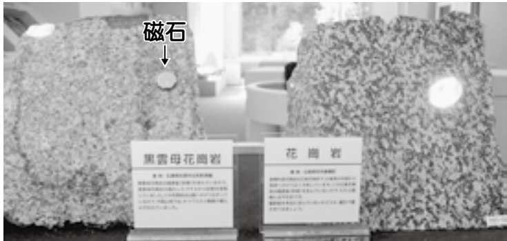
左：森脇の花崗岩(磁石がくっきます) 右：沿岸部の花崗岩
