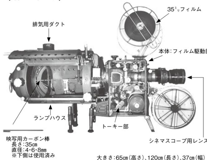
これは昭和40年頃、新響電機工業(株)で製造された、35mmフィルム上映用の「35mmアーク式小型映写機」です。
