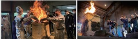
炉に砂鉄と木炭を交互に入れ、「ふいご」で風を送り砂鉄を溶かします。
