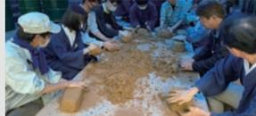
築炉用の粘土を練り、ブロックを作ります。炉に使用する土は操業の成否を決める重要な役目を果たします。
