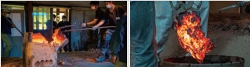
送風管を外し、長い柄のかぎで炉を崩し、鋸（けら）を取り出します。
