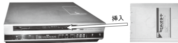
【図1】VHDプレーヤー 高さ10cm、奥行き36cm、幅40cm、重さ9kg 【図2】ビデオディスク 長さ34cm、幅27cm
