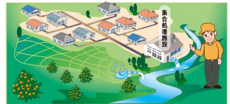
集合処理（下水道・農業集落排水施設）
