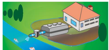
個別処理（合併処理浄化槽）
